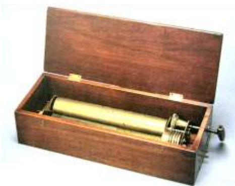
セクショナル コーム フュージ ムーブメント SECTIONAL COMB FUSEE MOVEMENT メーカー不詳 UNKNOWN 1800~1820 年頃 スイス 5.5cm×30.5cm(直径×長さ) H9×W44.5×D15
